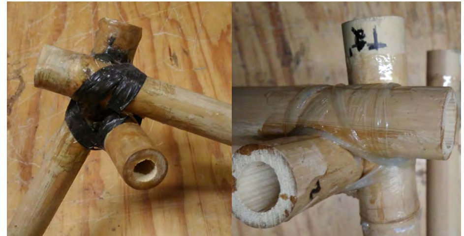
Unión con fibra de carbono y resina
