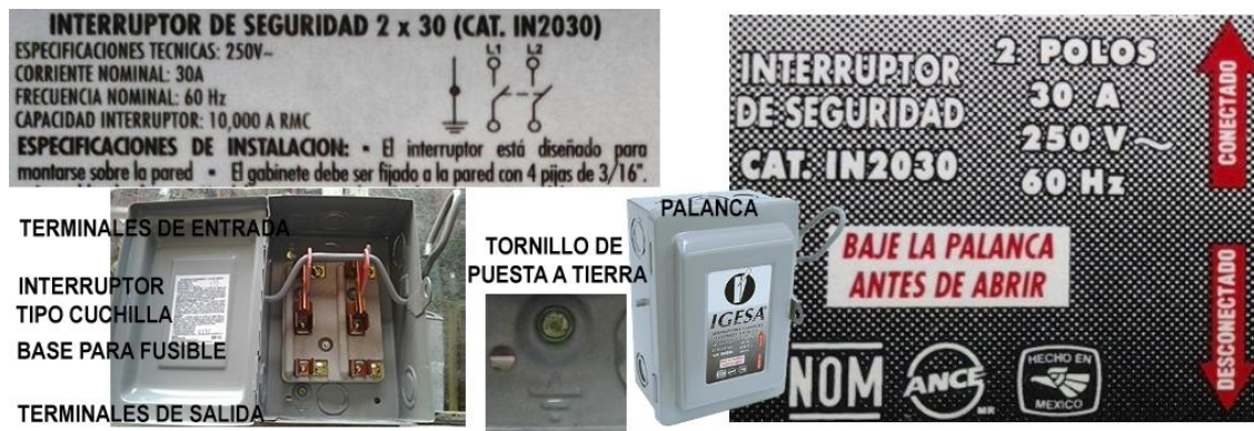
Imagen 93. Interruptor de seguridad con base para fusible (tipo cartucho clase H y K1). Adaptado de: www.igesa.com y www.muchoaterial.com el 19/10/2016
