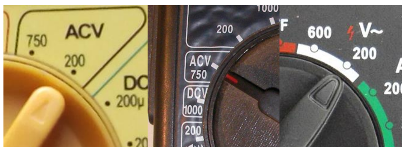
Imagen 118. Ejemplos de colocación del selector para medir voltaje en una instalación monofásica de 127 [V].
