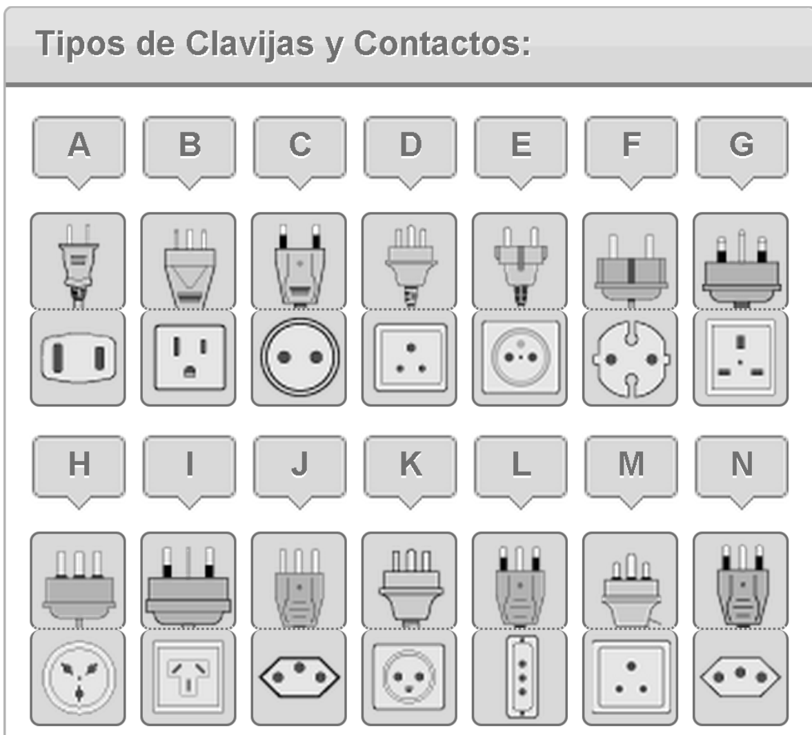
Imagen 43. Clasificación de Clavijas y Contactos hecha por la IEC. Obtenido de: http://www.iec.ch/worldplugs/map.htm# el 2/08/2015
