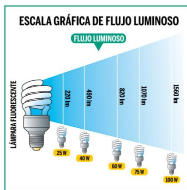
Imagen 84. Relación entre el flujo luminoso y la potencia de los focos incandescentes
