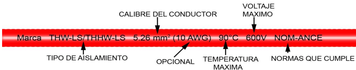
Imagen 26. Impresión en el exterior de un conductor.
