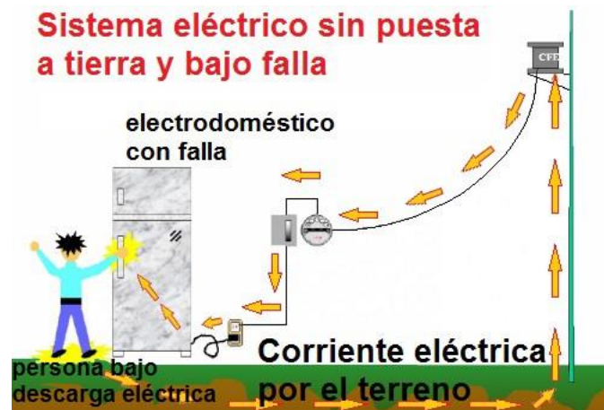
Imagen 57. Falla a tierra. La fase y la tierra se unen mediante la envolvente metálica del refrigerador y la persona.
