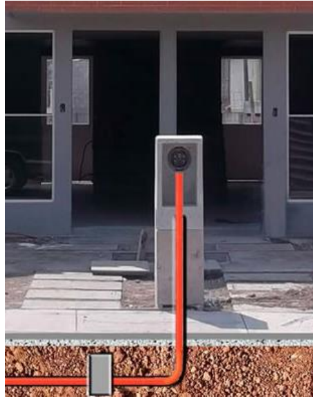
Imagen 39. Instalación Conduit de polietileno. Obtenido de: http://electrica.mx/wp-content/uploads/2015/07/not3.jpg el 29/07/2015
