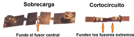
Imagen 59. Operación del eslabón-fusible. Fuente Mercury y Karp™.
