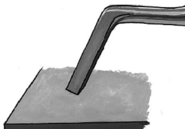
Fig. 22.- Afilado correcto de la hachuela
