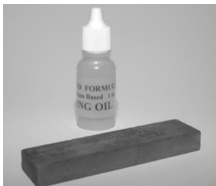
Fig. 21.- Piedra de afilado y aceite mineral
