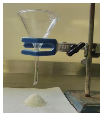
Figura 4. Determinación de ángulo de reposo por el método embudo a altura fija
