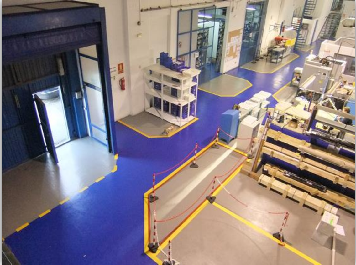
Figura 11. Aplicación de 5'S.
