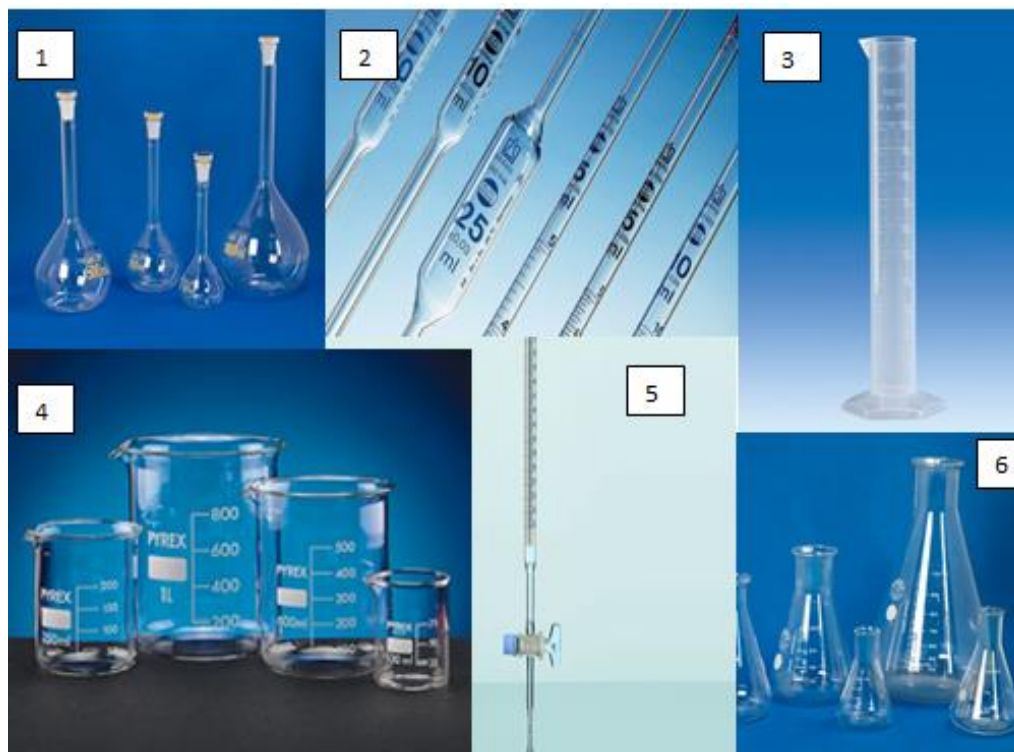
Figura 13. Instrumentos de laboratorio. 1. Matraz volumétrico 2. Pipetas 3. Probeta 4. Vaso de precipitados 5. Bureta 6. Matraz Erlenmeyer Fuente: varias; elaboración propia.
