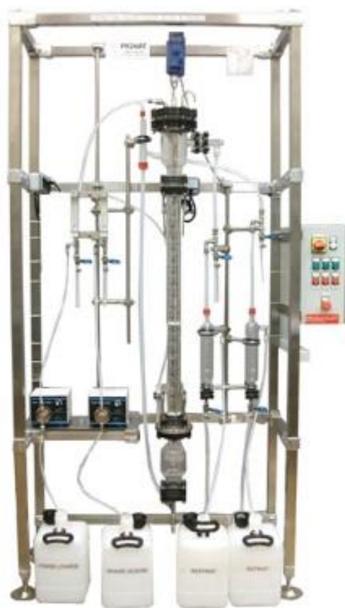
Imagen 5.1.1 Columna de absorción Pignat Ubicada en la Facultad de química.
