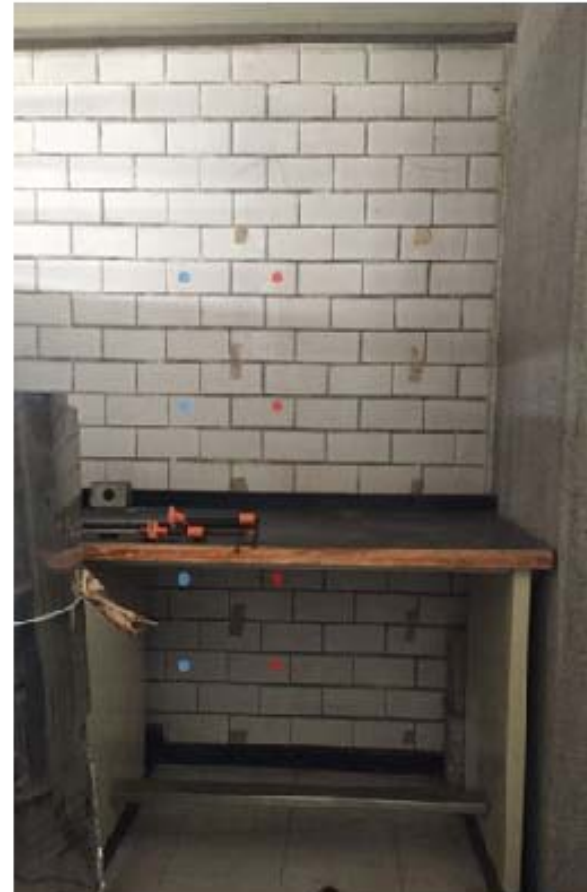
Figura 26. Ubicación de los módulos en la cara interior del muro. Puntos rojos y azules indican posición del termómetro infrarrojo para la toma de temperaturas en la ubicación de módulos y en el área en donde no se fijaron. Fuente: Elaboración propia
