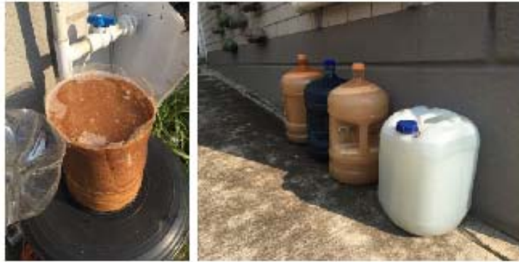
Figura 25. Izquierda, filtro de aserrín para grasas y aceites, derecha, garrafones conteniendo agua gris Fuente: Elaboración propia
