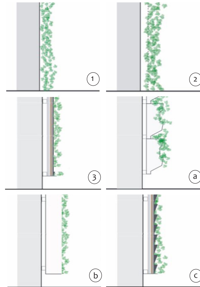
Figura 7. Fachadas Verdes: 1)Directas, 2)Indirectas, Muros vivos: 3) Continuos 4) Modulares, a) jardineras b) bandejas c) bolsas flexibles Fuente: Adaptado de Perini et al, (2011 a )
