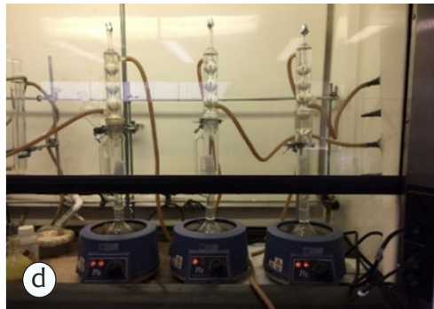
Figura 24. a) Muestra de agua del afluente y del efluente para análisis de turbidez, b) Proceso de filtrado por succión con matraz, Crisoles Gooch y microfibras filtrantes para retener los SST, c) Proceso de filtrado por succión con matraz, Embudo Buchner, papel filtro de poro fino para retener grasas y aceites, d) Equipo Soxhlet y cartucho de extracción de celulosa con papel filtro, e) Empleo de termómetro de mercurio para toma de temperaturas enfrente de módulos, f) Empleo de termómetro digital para toma de temperaturas en la parte posterior de módulos.
