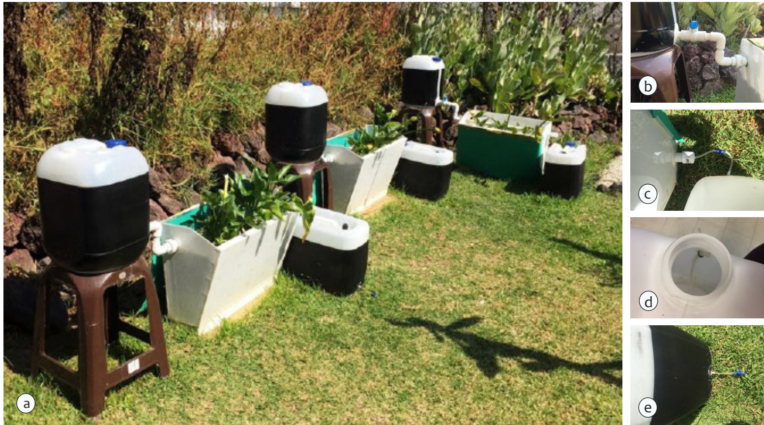
Figura 13. a) Módulos humedal con sistema de alimentación a base de recipientes plásticos, b) Recipiente de almacenamiento de agua preparada con conexiones al tubo de entrada del módulo. c) Conexiones a recipiente de recolección de agua de salida, d) Manguera fijada al interior de recipiente de salida. d) Manguera con válvula en recipiente de salida. Tomada en el jardín del Centro Tecnológico de la FES Aragón
