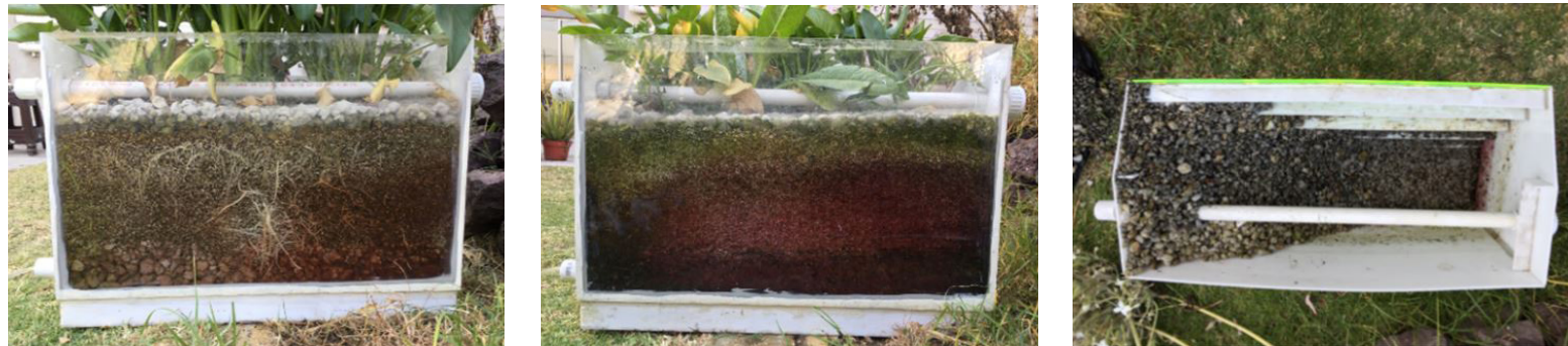
Figura 21. Cara posterior de H1 y H2 de izquierda a derecha, que muestra el crecimiento de algas en la capa superior del H2. También se observa un mayor desarrollo de raíz en el primero. Se muestra además la presencia de humus dentro de los humedales, así como en H3 (extremo derecho) en el proceso de desmontaje del sistema.
