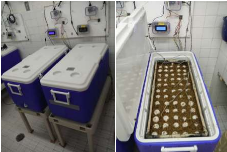
Figura 8. Fotografías de la distribución y configuración de las incubadoras dentro del cuarto de incubación.
