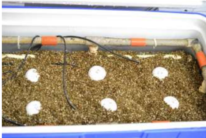
Figura 17. Incubadora experimental "Reactor" con la plataforma para el sustrato y los huevos, además de los cables del calentador y sensores. Se programó para iniciar a 28° o 32°C y realizar incrementos graduales de temperatura a una tasa de 1.5°C/hr mediados por el sistema Arduino .
