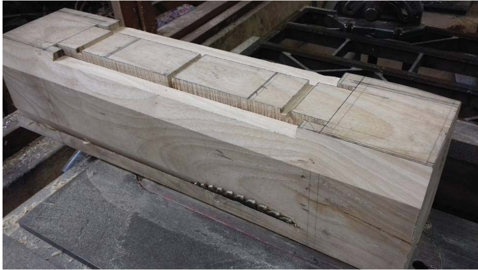
Fig. 71. Proceso de construcción de un Teponastli de Ángel de la Serna.
