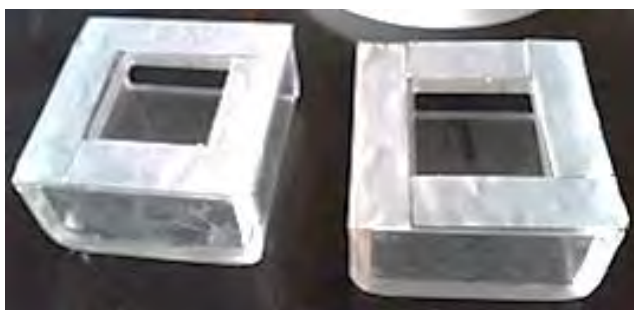
Ilustración 15 Contenedores de ánodo y cátodo
