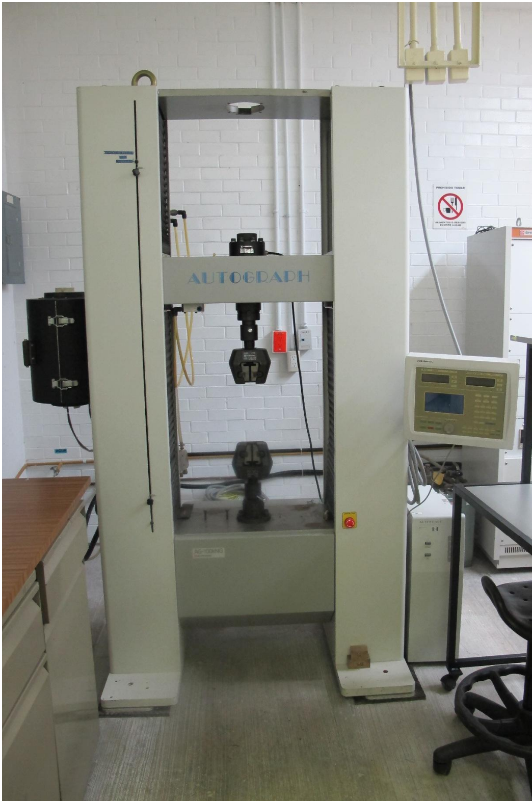
Imagen 9. Máquina de pruebas universales SHIMADZU modelo AG-100KNG, Laboratorio de Cristalofísica y Materiales Naturales del Instituto de Física de la UNAM.
