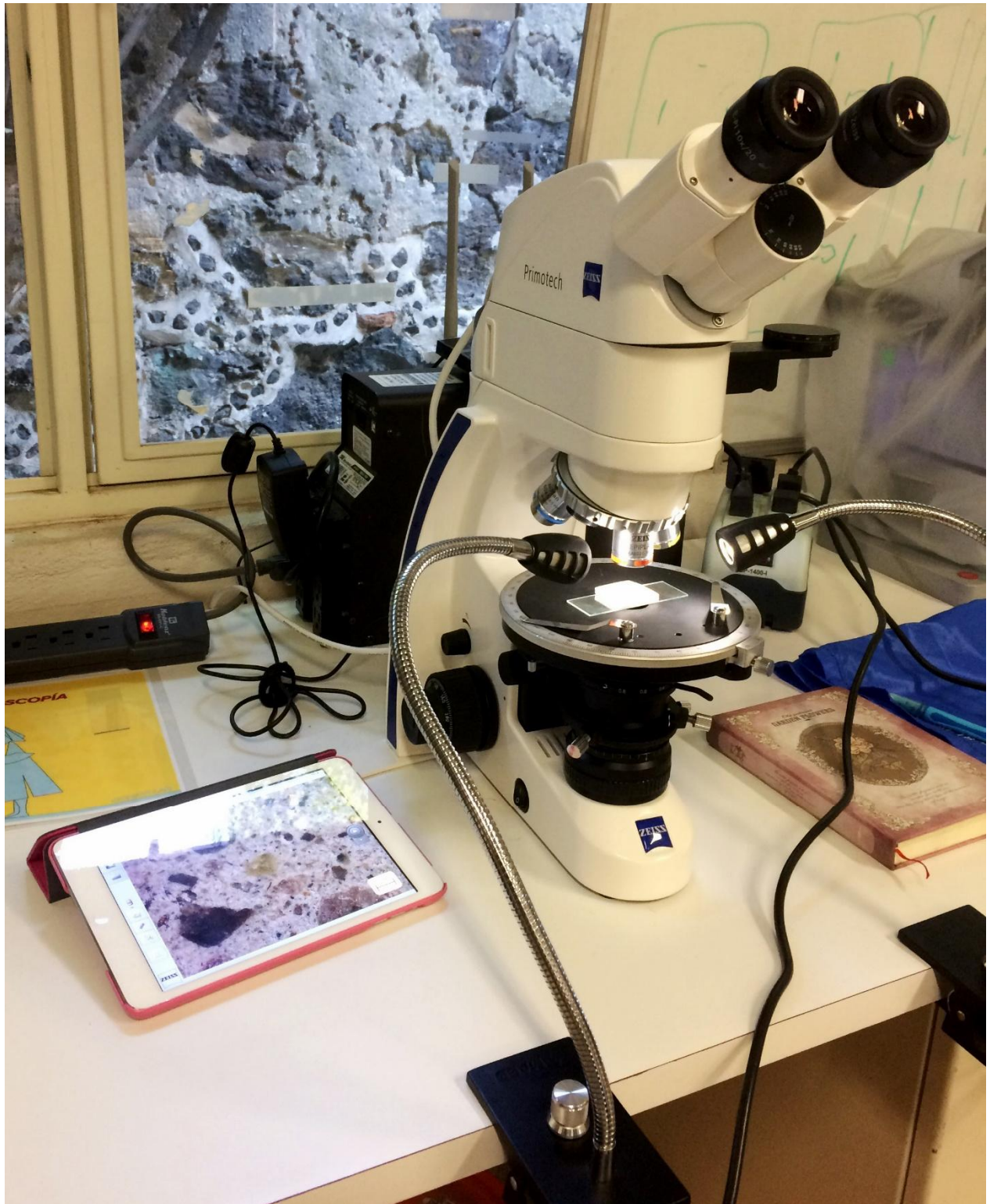
Imagen 6. Implementación del Microscopio estereoscópico con filtro polarizador marca ZEISS modelo Primo Tech para llevar a cabo el estudio petrográfico.
