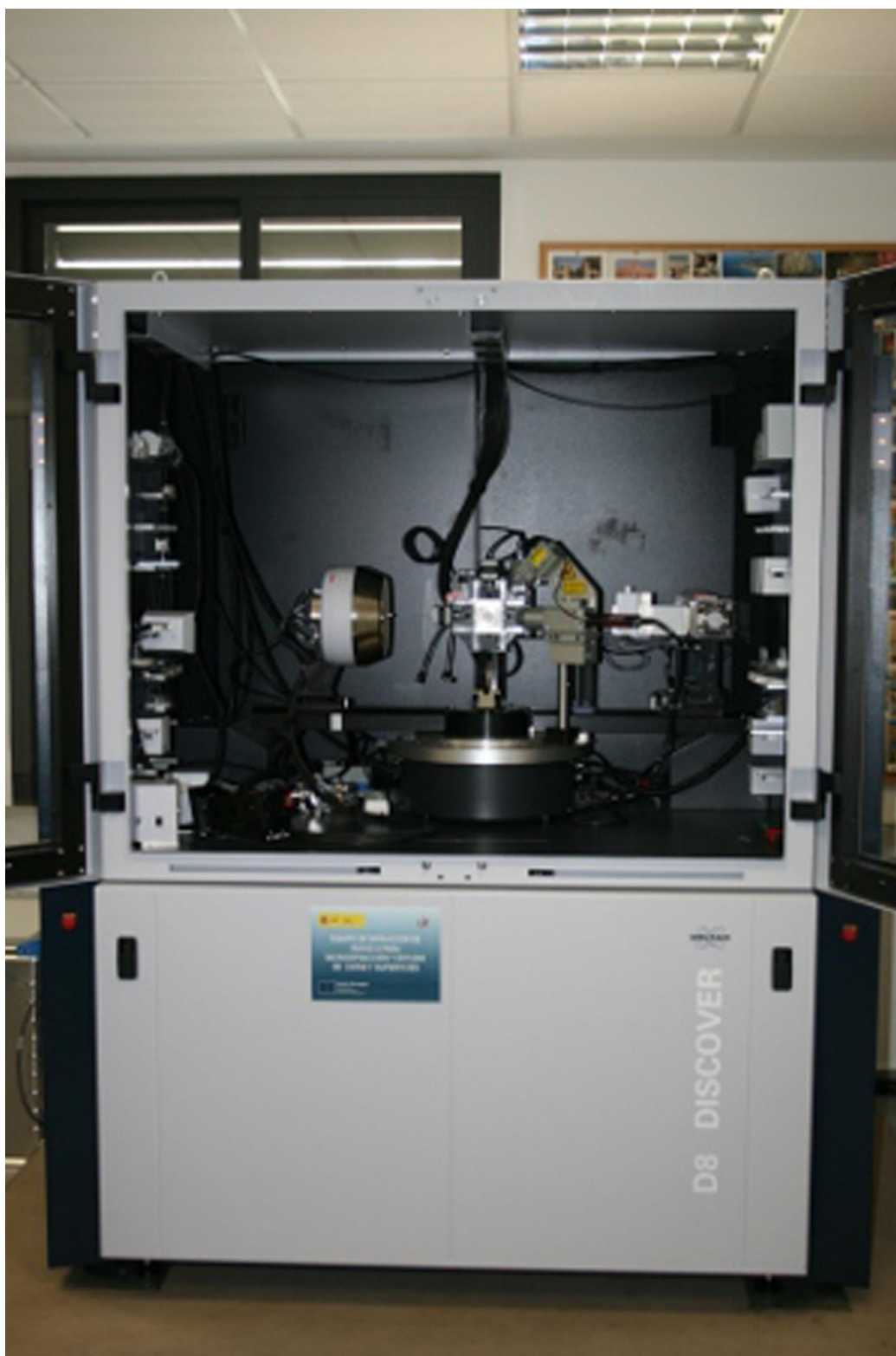
Imagen 8. Difractómetro modelo D-8 Discover BRUKER del Laboratorio de Refinamiento de Estructuras Cristalinas del Instituto de Física de la UNAM.
