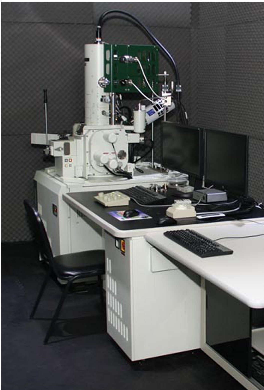
Imagen7. Microscopio Electrónico de Barrido JSM – 7800 F, Laboratorio Central de Microscopia del Instituto de Física de la UNAM.
