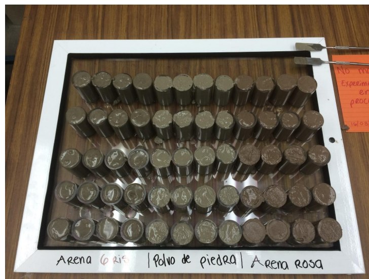
Imagen 4. Elaboración de probetas realizadas con cemento C 1 para pruebas mecánicas.
