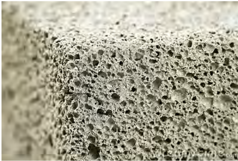
Ilustración 1 El concreto ligero estructural presenta una densidad menor al concreto convencional.
