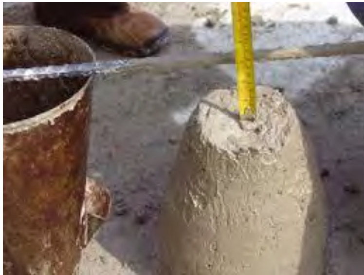
Ilustración 10 Revenimiento (el concreto no se desploma como un concreto normal)
