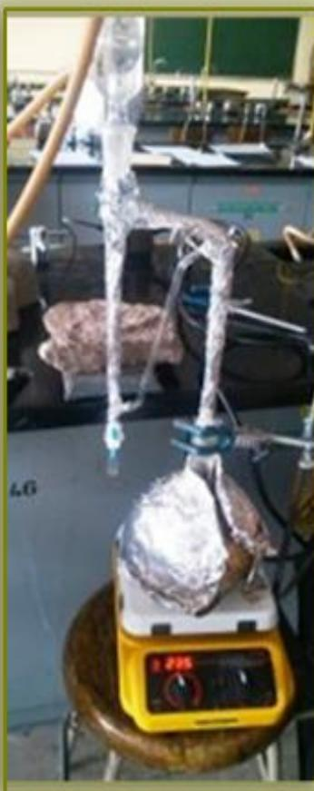
**Figura 14.** Equipo de hidrodestilación con una trampa tipo Clevenger
