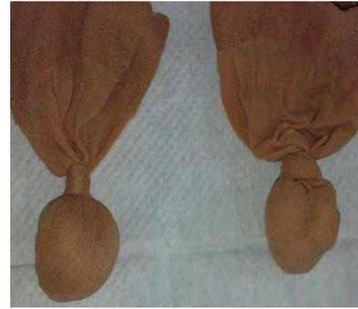
*Figura 15. Cargas bacterianas para la reactivación del consorcio microbiano funcional en reactor biológico de membrana y por lote.*
