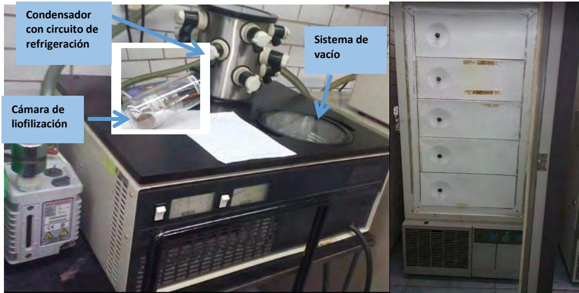
Figura 9. Equipo de liofilización marca LABCONCO
