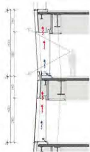
Esquemas de configuración en fachada y sistema de ventilación de doble fachada
