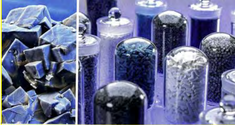
Figura 13. MOF cristalizados de diferentes tamaños para almacenar gas natural.
