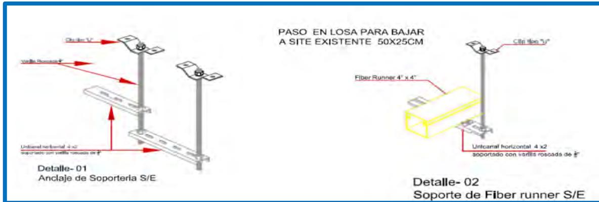
Fig. E4.15. Detalle de la soportería 1, del Data Center.
