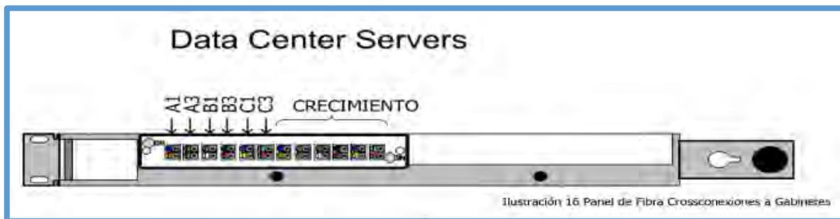
Fig. E4.11. Vista frontal de cross-conexiones a los gabinetes.
