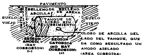
Figura 4.20. Suelos Distintos. Las variaciones en el tipo de suelo o sus propiedades tales como acidez o resistividad puede llevar a la corrosión de una estructura de acero subterránea
