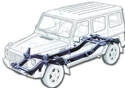
Figura 1.1 Chasis tipo escalera del Mercedes-Benz Clase G del 2002 [Mercedes-Benz USA, 2002]
