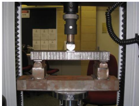
Figura 3.3 Ensayo de flexión en 3 puntos realizado por el equipo ECU Racing [James, 2010]
