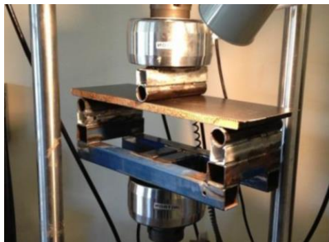
Figura 3.7 Configuración de la prueba a flexión en 3 puntos hecho por “Cal Poly Racing” [Hagan, 2014]
