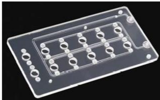
Figura 8 [6] Carga útil del Gene-Sat 1: dispositivo microfluídico.
