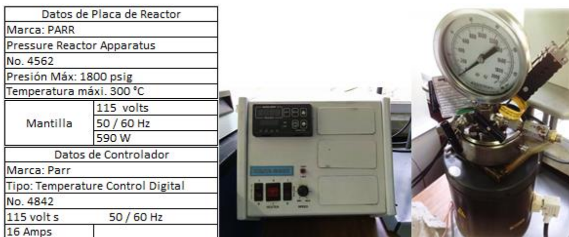
Figura 13. Sistema de reacción para la hidrólisis ácida.
