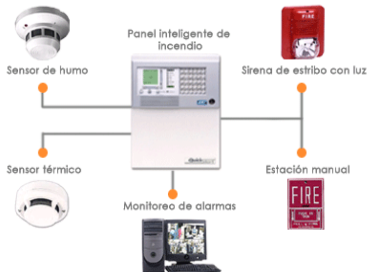
Imagen 96. Elaboración Pinterest (2017), Tipo sistema contra incendio.
