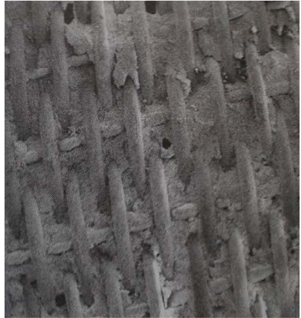
Img. 41. A la izquierda, fibra textil con poca penetración por parte de la matriz cementaria.
