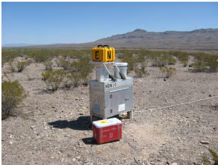
Figura 8. Equipo para el muestreo del depósito húmedo para mercurio utilizado en la red US NADP/MDN, estación ID NM 10, Caballo/Sierra, Nuevo México. Ubicación: latitud 33.0625 y longitud -107.2917.
