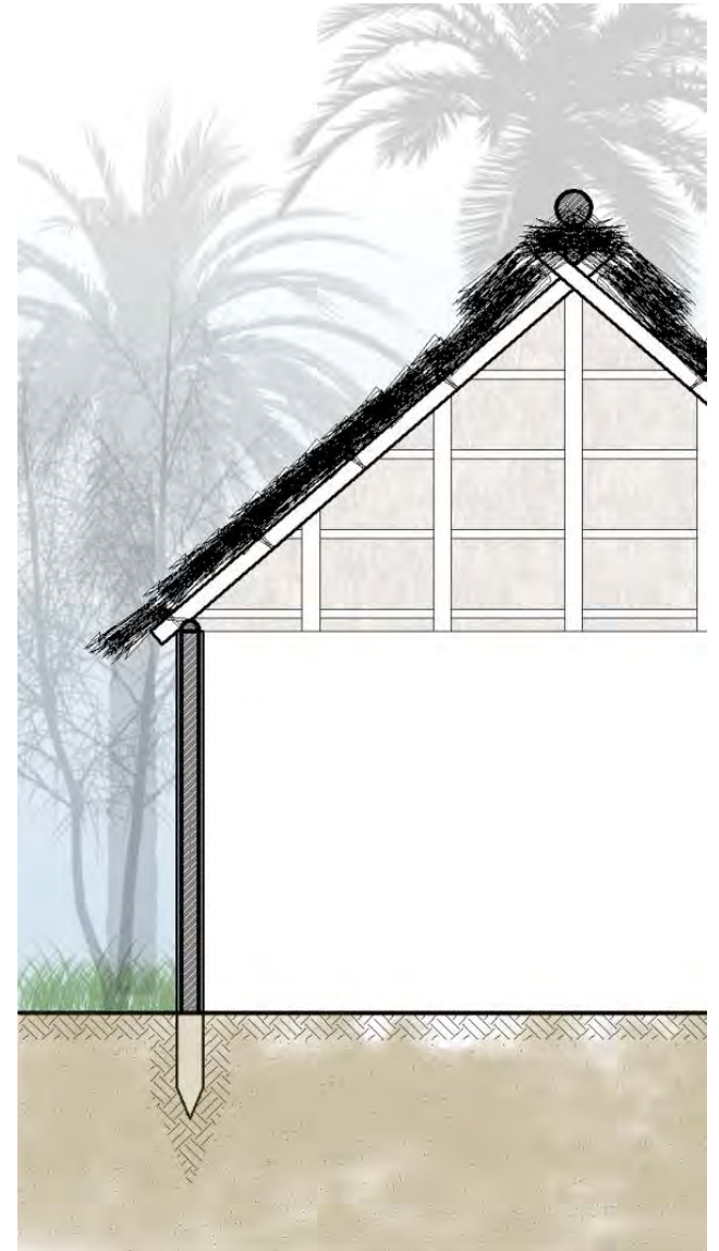
Ilustración 36. Corte arquitectónico de método constructivo tradicional, con estructura de madera, muros de bahareque, techumbre de madera y cubierta de palma.
