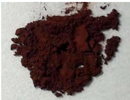
**Figura 12.** Ferrita de cobre, CuFe<sub>2</sub>O<sub>4</sub>
