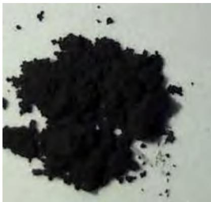
**Figura 10.** Ferrita de cobalto,  $\text{CoFe}_2\text{O}_4$
