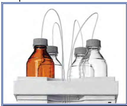
Figura 7. Reservorios sobre un sistema de HPLC cuaternario
