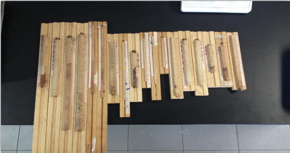
**Figura 9. Muestras colectadas, montadas en los bastidores, lijadas y pulidas.**
