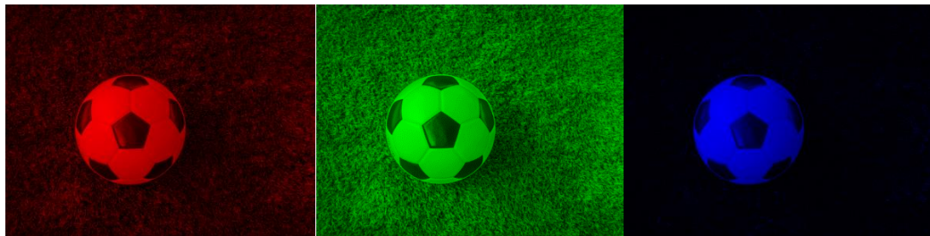
Ilustración 2-7 Descomposición de la imagen de un balón en los colores primarios RGB
