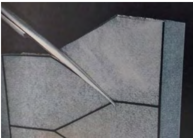
Fig. 8 Corta la hoja de platino en la forma necesaria. 20
