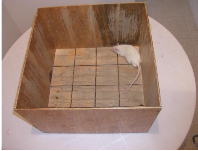
Fotografía 3. Muestra una caja o campo abierto de madera con medidas de (40x40x30 alto) el cual fue dividida en 16 cuadrantes de 10x10 cm. La caja está iluminada con luz tenue (7lux) (Hernández-Gómez et al., 2002).
