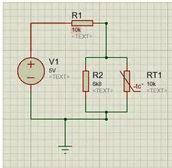
Figura 5.10. Linealización del termistor con una resistencia en paralelo y un resistor en serie formando un divisor de tensión, todo esto es alimentado por una fuente a 5 [V]
