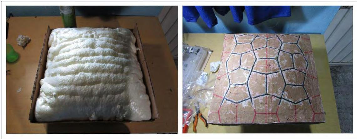
*Figura 2.10. Asiento prototipo de espuma de poliuretano*
