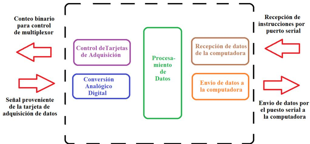
Figura 5.18. Funciones del subsistema de procesamiento de datos
