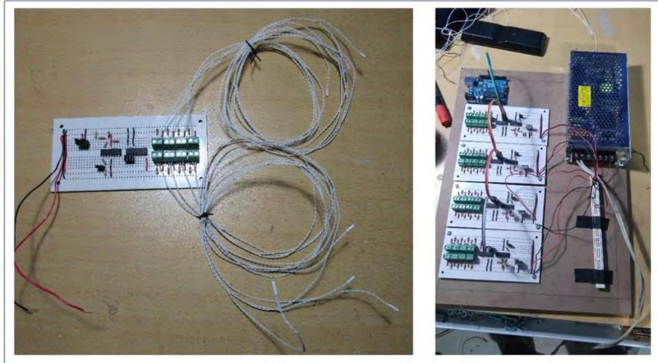
*Figura 2.11. Prototipo de tarjeta de adquisición de datos*
