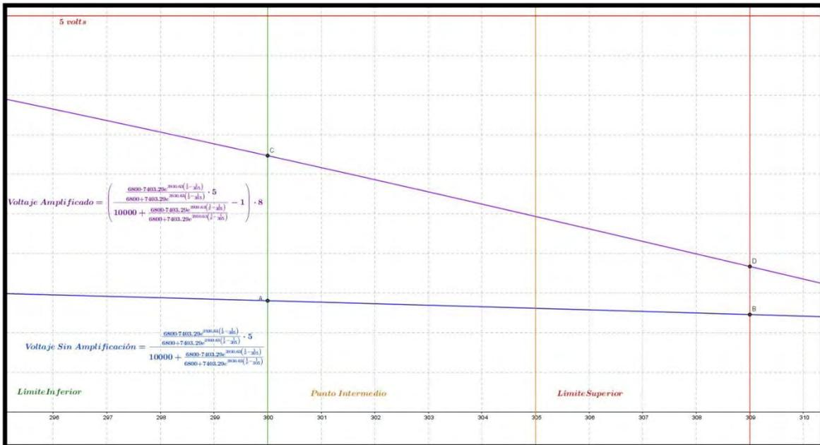
*Figura 5.9. Gráfica de la señal del termistor a la cual se le resta 1 [V] y se amplifica por 8 (curva morada) y gráfica de la señal del termistor sin restar ni amplificar (curva azul), la línea roja indica la región de saturación*
