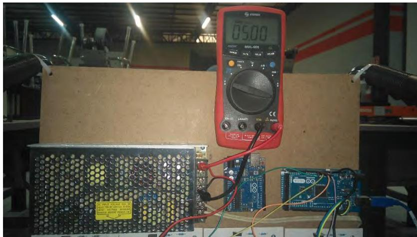
*Figura 5.26. Calibración de la fuente de poder*
