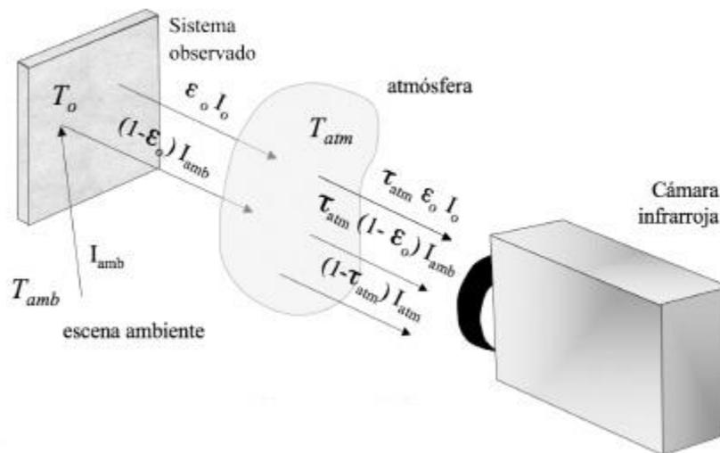
Figura 4.1. Elementos que intervienen en un ensayo de termografía infrarroja. Imagen obtenida de Baladegas, 2007
