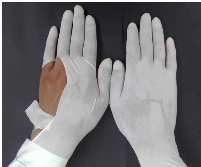
Figura 47 Guante desgarrado por colocación.
