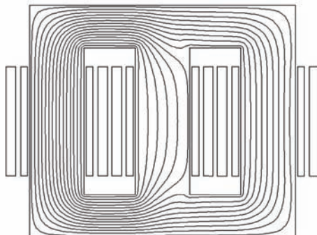
Figura 5.7: Distribución del flujo magnético ( \omega t = 0 ) a carga nominal.
