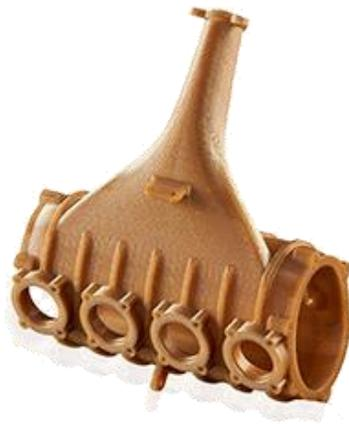
**Figura 3.17. Pieza impresa con ULTEM 1010.**
