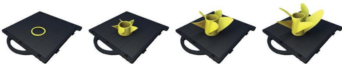
**Figura 2.8. Proceso de creación de un álabe por medio de la impresión FDM.**
