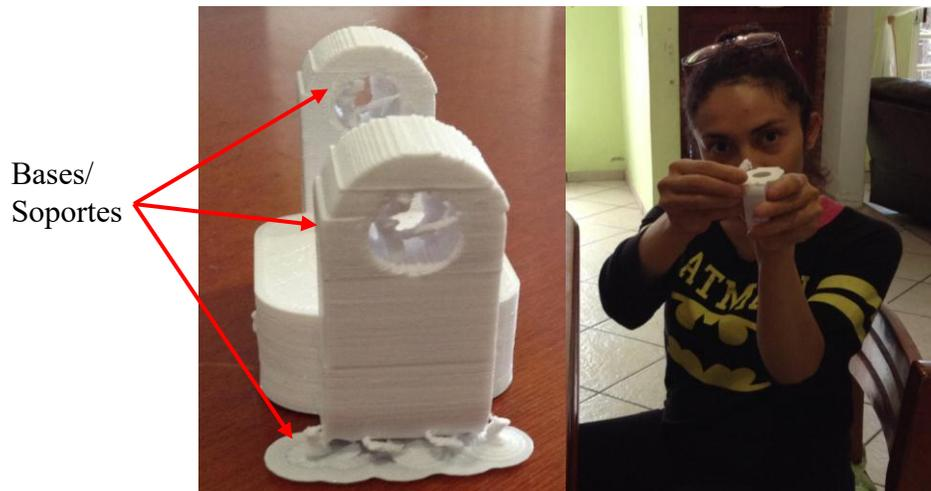
*Figura 5.31. Desprendimiento manual de los soportes.*
