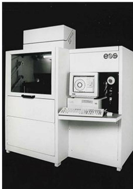
***Figura 1.5. Primera máquina “Stereos” de la compañía EOS GmbH fabricada en 1991.***
