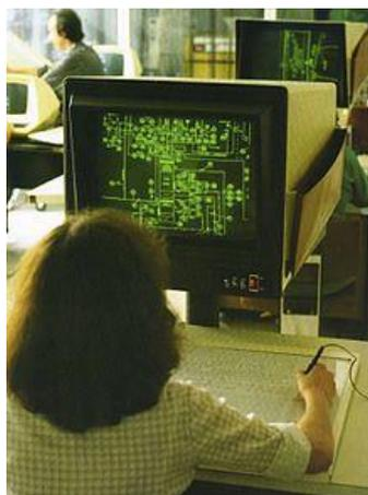
***Figura 1.9. Sistema CADDS3 de la compañía Computervision siendo utilizado para realizar un diagrama de tuberías e instrumentación en 1979.***
