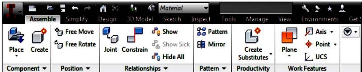
**Figura 4.4** Tabla “Assemble” y sus herramientas.
