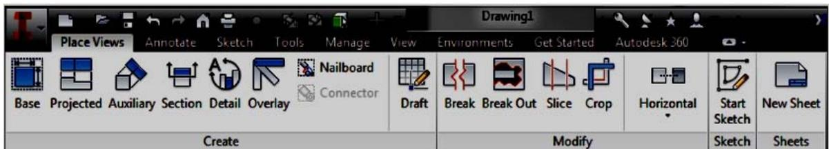
**Figura 4.5** Tabla “Drawing” y sus herramientas desplegando la pestaña “Place Views” y a su lado la pestaña “Annotate”.
