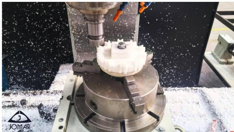
**Figura 2.2. Mecanizado de polímeros por manufactura sustractiva.**
