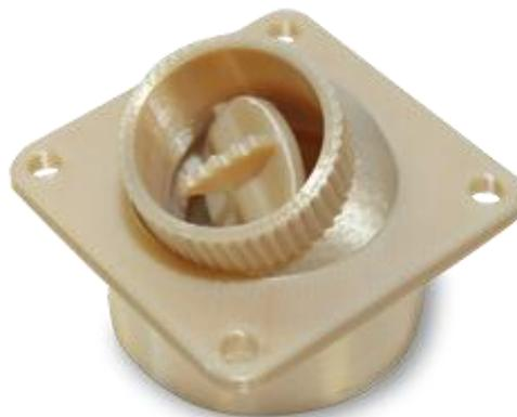
**Figura 3.16. Pieza impresa con ULTEM 9085.**
