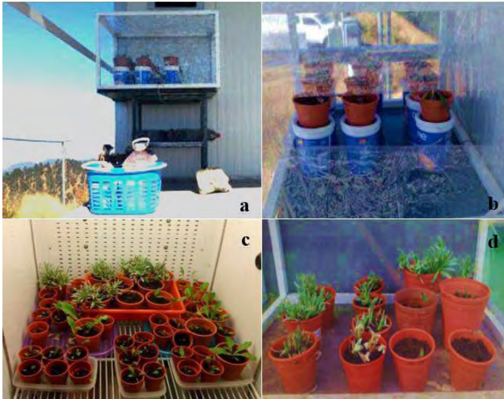
Figura 11. a) y b) muestreadores con plantas expuestas, protegidas de la lluvia en la estación ALTZ, c) cámara de crecimiento con condiciones controladas de temperatura, humedad y luz, d) muestreadores en la azotea del CCA, expuestas al ambiente, protegidas de la lluvia.
