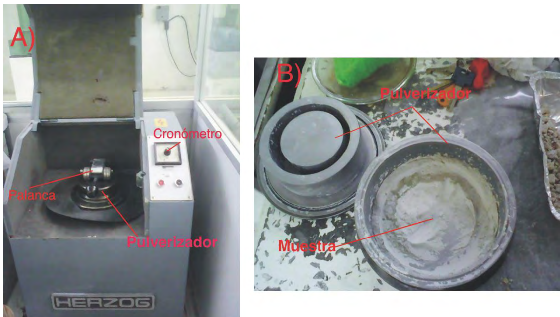
Figura 1.4. A) Molino vibrador Herzog H100, donde se logran apreciar las partes que emplea el aparato para pulverizar las muestras. B) se observa el pulverizador con la muestra.
