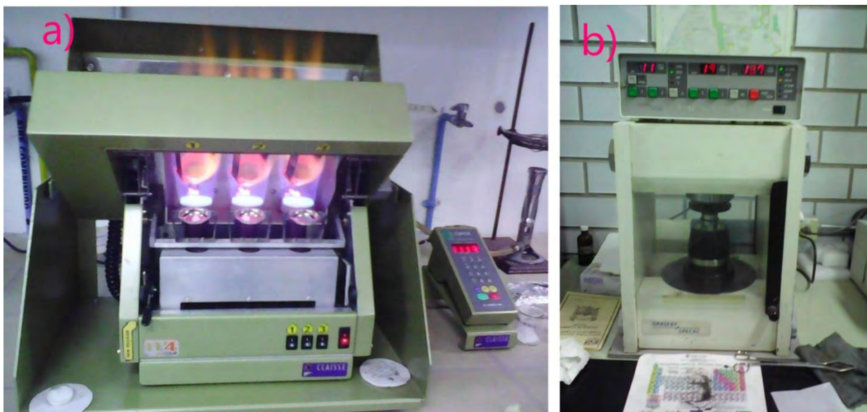
Figura 1.5. a) Horno tipo Claisse, utilizado para fundir las muestras y realizar pastillas de vidrio, para realizar análisis de elementos mayores. b) prensa automática tipo GraseBy Apecac utilizada para hacer pastillas las cuales son utilizadas para realizar los análisis de elementos traza.
