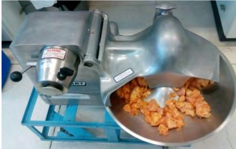
Figura 8. Molienda en cutter
