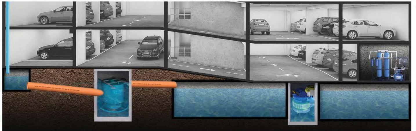
CAPTACIÓN / SEPARACIÓN / TANQUE DE TORMENTAS / VÁLVULA DE CONTROL / FILTROS / ALMACENAMIENTO
