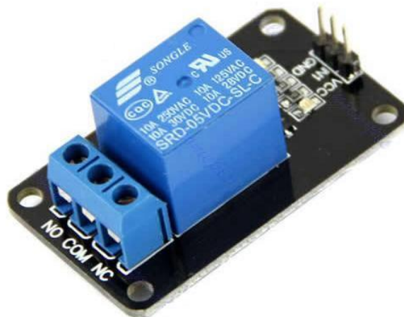
Ilustración 26 Módulo con relevador unitario
