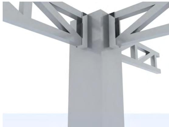
La propuesta de estructura en la torre es de columnas con traveses metálicas las cuales serán fijadas por medio de soldadura y que además cuenta con un sistema de fijación a la estructura del sótano a través de placa soldada a columnas de acero.
