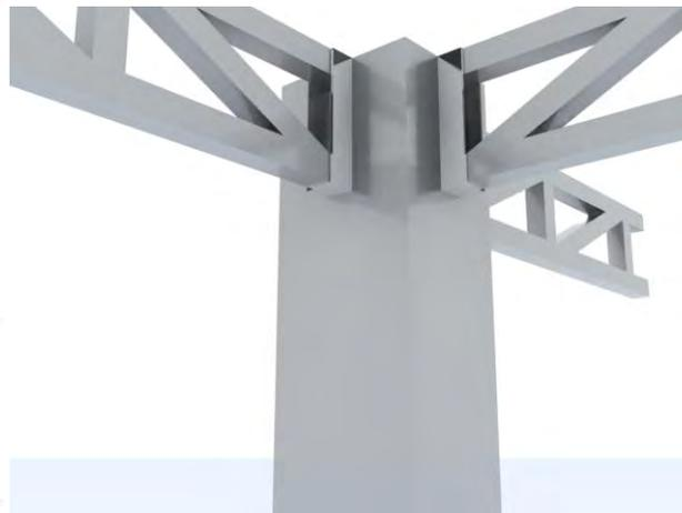
Los elementos horizontales son a base de vigas IPR las cuales serán usadas en sentido mas largo del terreno conectando las columnas metálicas con longitudes máximas de 10 m.
