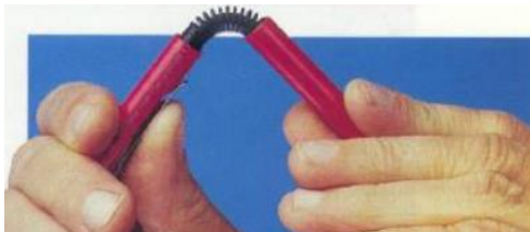
Figura 2.5. Componente de plástico que actúa como resorte [3]
