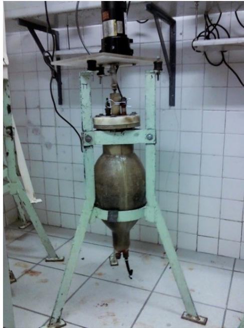
**Figura 5.** Digestor anaerobio semilla.
