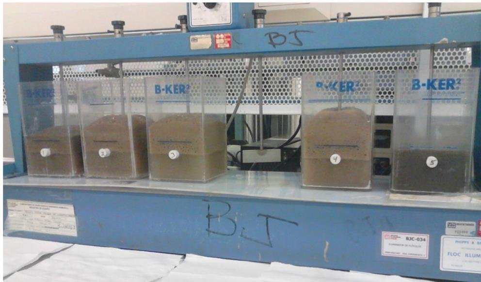
**Figura 4.** Preparación del pretratamiento de los lodos con APA.
