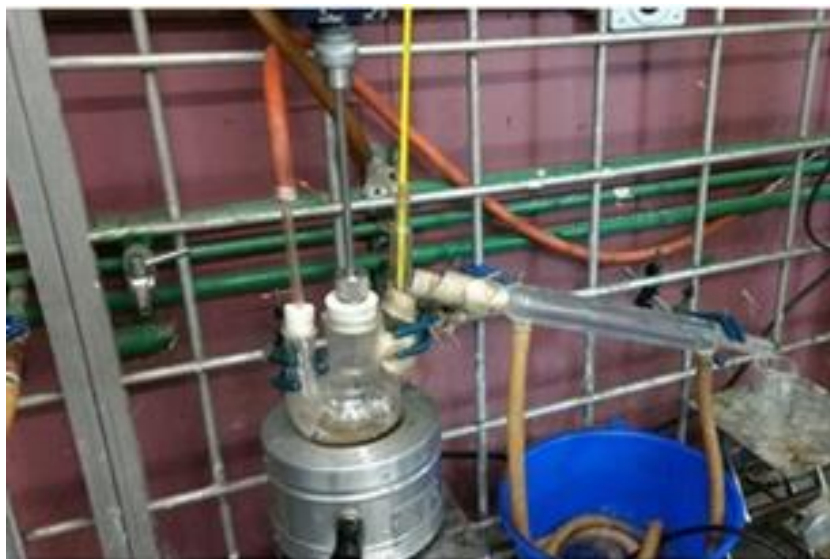
Figura 33. Reactor de esterificación
