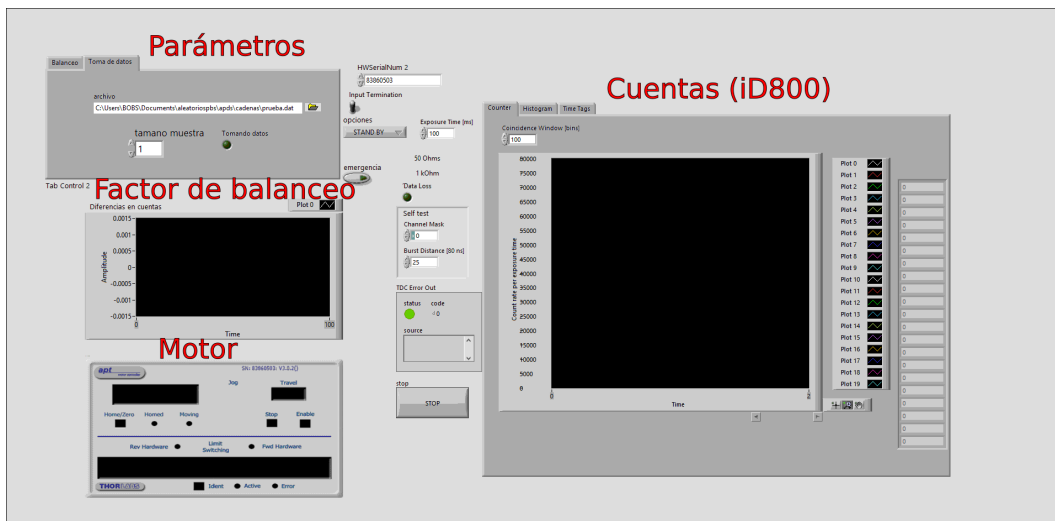
Figura B.7: Imagen de la interfaz del programa implementado en LabView. Desde aquí se puede modificar los parámetros, ver la evolución del factor de balanceo, el ángulo actual del motor y las cuentas en cada canal. Los datos se actualizan en tiempo real.
