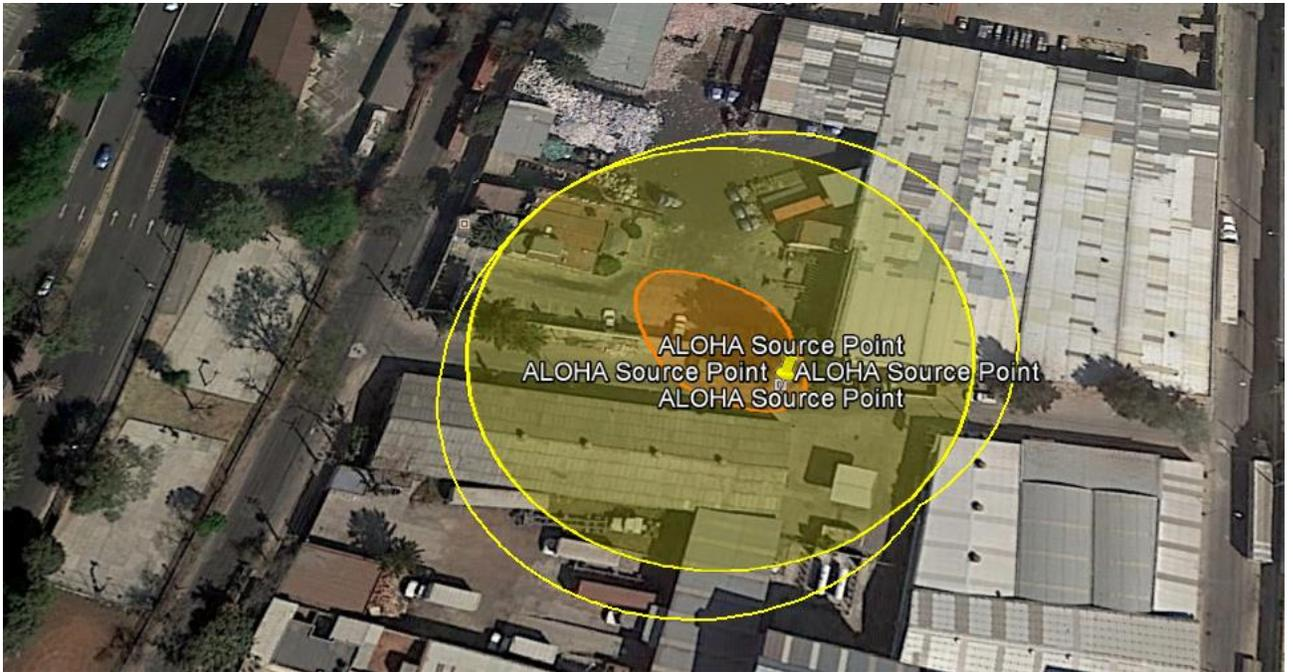
Figura 12. Vista de zonas de sobrepresión por explosión de gas propano. Vientos provenientes del sureste.
