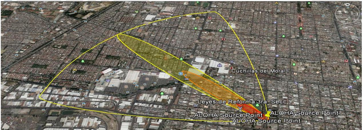
Figura 9. Vista de zonas afectadas por concentración de cloro. Vientos provenientes del sureste.
