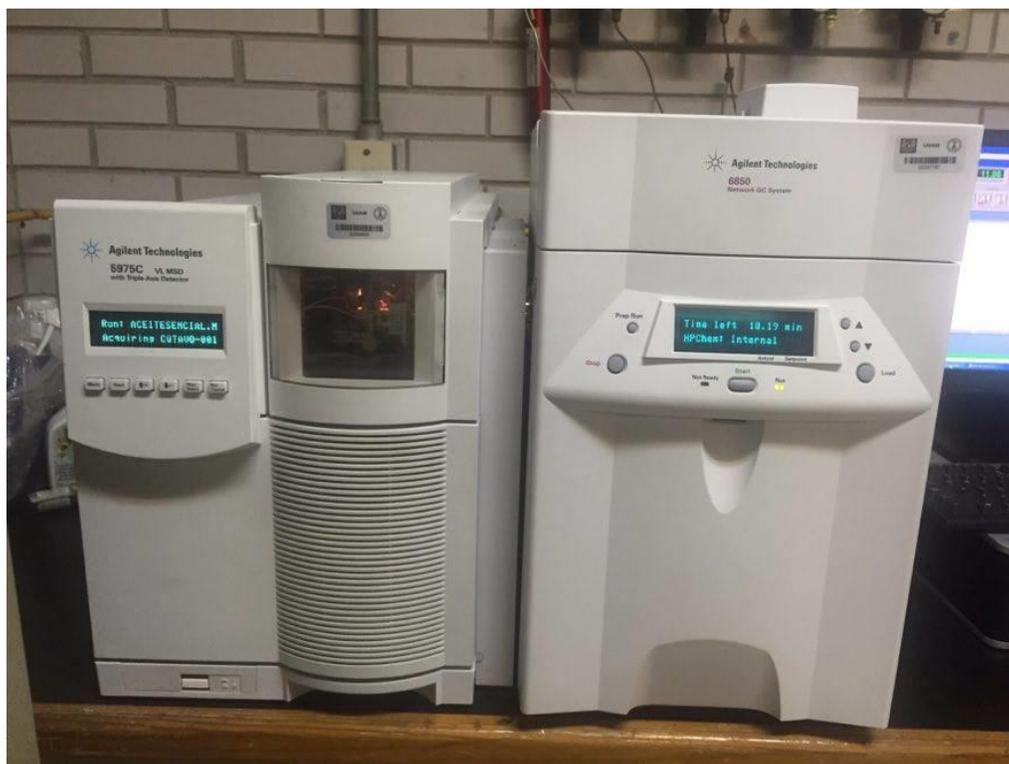
Figura 16. Cromatógrafo modelo 6850 y espectrómetro de masas modelo 5975C (Foto tomada en octubre, 2016).
