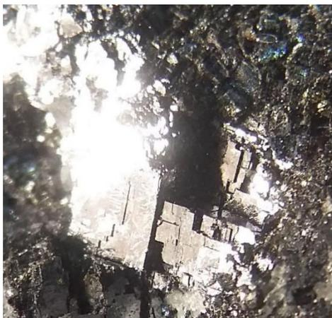
Figura 2.1.1 Cristal de Galena, Microscopio óptico a 20 X.
