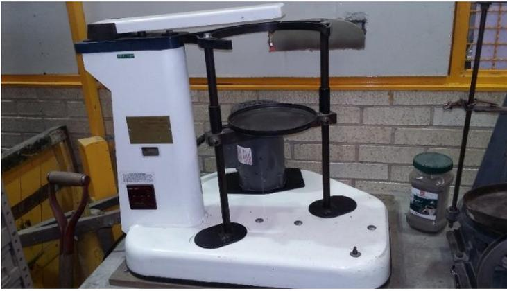
Figura 2.3.2.A Tamizadora de laboratorio Ro-Tap® W.S. Tyler
