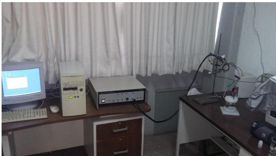
Figura 1.5.B Equipo para VC: Ordenador, Versastat I y celda de tres electrodos.
