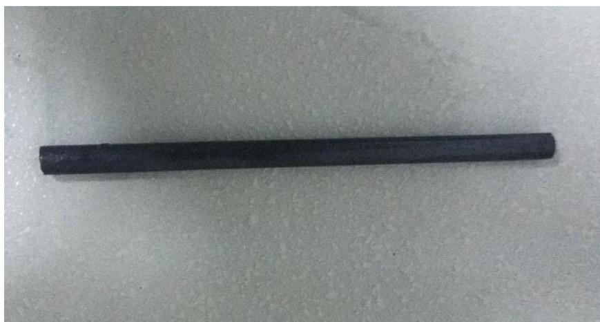
Figura 1.7.C Electrodo de grafito 5mm de diámetro.
