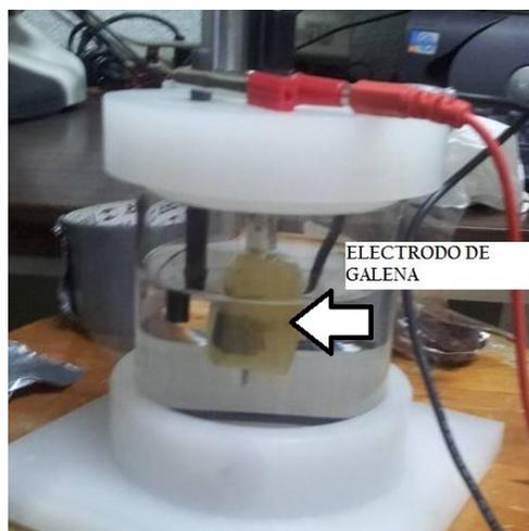
Figura 1.6. Celda de trabajo experimental de tres electrodos.
