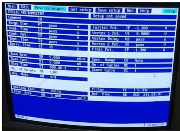
Figura 2.2.2 Interfase del Programa para determinar las condiciones de barrido de potencial.
