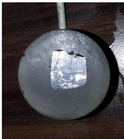
Figura 1.7.A Electrodo de Galena dentro de resina dieléctrica, conectado a Cable de Cobre, área aproximada  $1.23 \text{ cm}^2$
