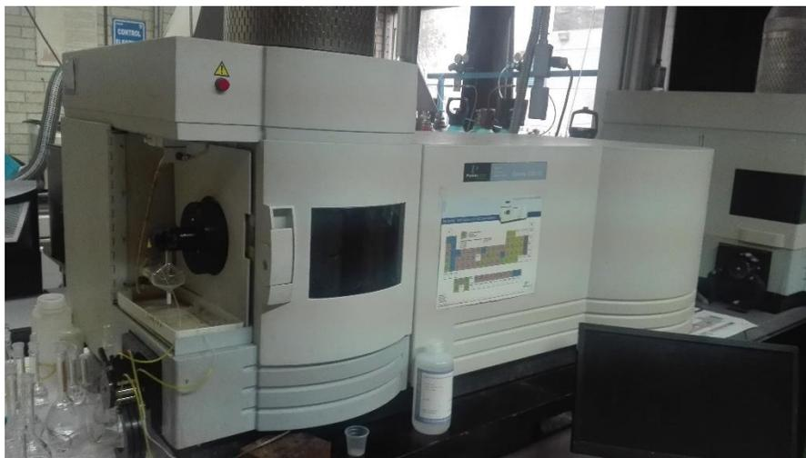
Figura 2.1.3. Equipo de análisis vía húmeda un equipo ICP-OES
