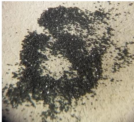
Figura 2.3.2 Muestra del mineral de PbS-ZnS que se usó durante las flotaciones 60 X.
