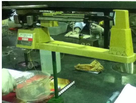
**Figura A.1.A Balanza granataria con sistema para medir tensión superficial.**
