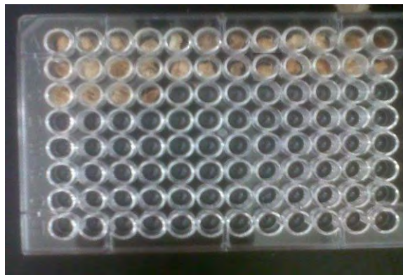
Figura 34. pellets de algodón extraídos y pesados inmediatamente y puestos en una placa de ELISA para su secado.
