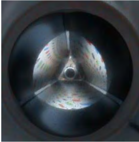
Figura 11. Prueba de pantalla nula con gotas de color
