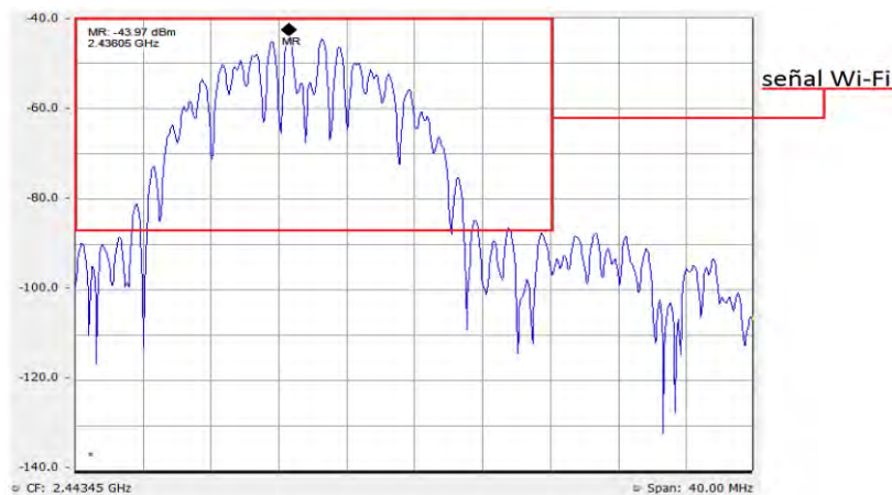
Figura 6.1 Señal Wi-Fi en el dominio de la frecuencia
