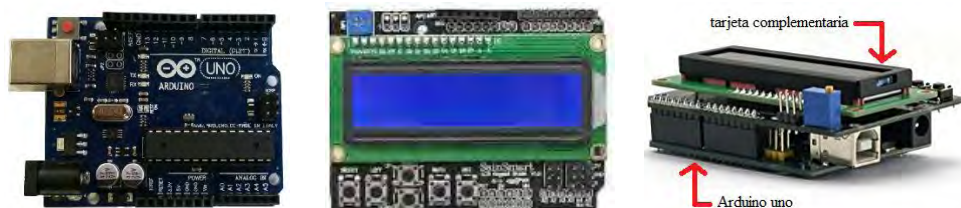
b) Tarjeta Arduino UNO y tarjeta de expansión LCD
